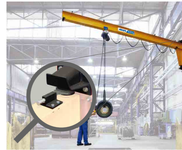
Regulación de resistencia a giro (fig. 10)
