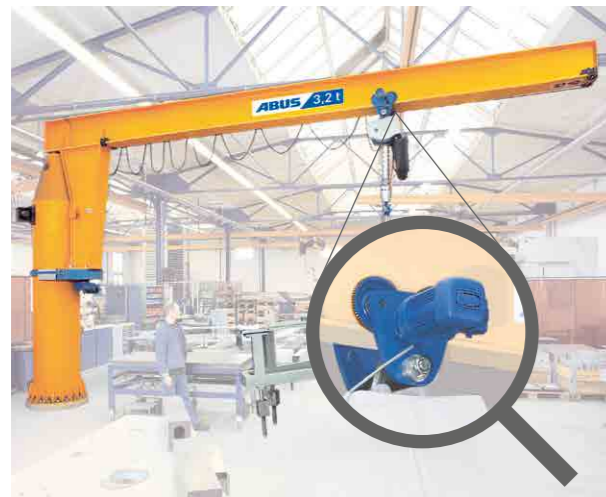
Traslación eléctrica del carro (fig. 1)
