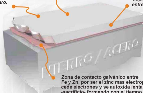
Zona de contacto galvánico entre Fe y Zn, por ser el zinc más electropositivo cede electrones y se autoxida lentamente -sacrificio- formando con el tiempo carbonatos básicos y anulando virtualmente la oxidación del metal base.
